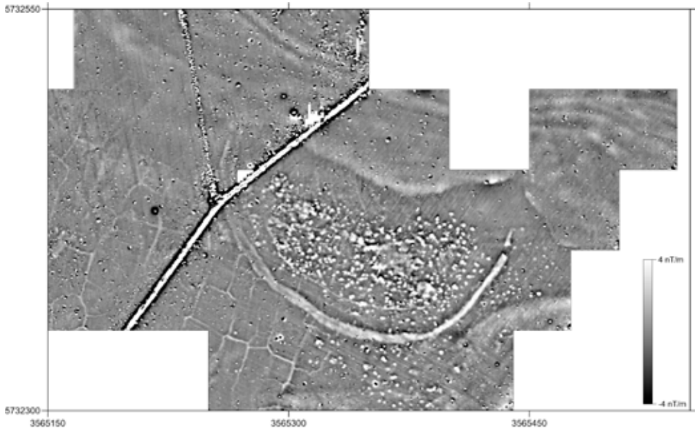
Abb. 4. Hollenstedt, FStNr. 2 (Stadt Northeim, Niedersachsen). Magnetogramm (Fluxgate-Gradiometer Förster Ferex 4.032 DLG 4-fach CON650, Raster 0,5 \times 0,2 m; Dynamik der Messwerte: -4/+4 nT/m; Skala: 256 Graustufen linear). M. 1:2000
