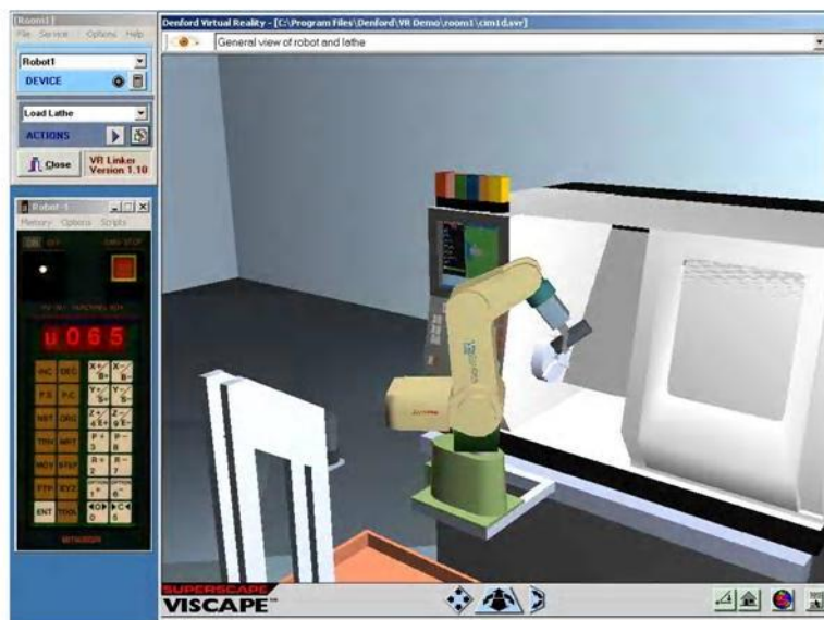
Rys. 6. Wirtualny robot VR Denford podczas pracy w elastycznym gnieździe obróbkowym
