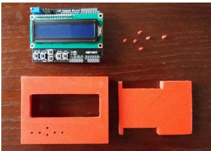
Rys. 3. Nakładka LCD 1602 KEYPAD wraz wydrukowaną obudową
