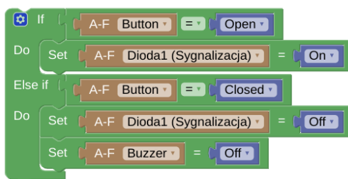
Rys. 6. Zdarzenie opisujące działanie sygnalizacji
