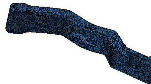
Rys.18. Model szczęki z nałożoną siatką elementów skończonych
