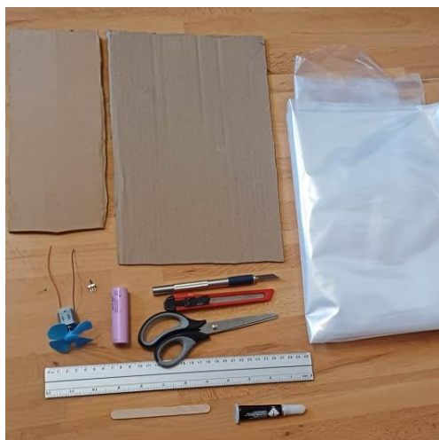
Rys. 3. Materiały potrzebne do wykonania modelu poduszkowca z napędem elektrycznym Źródło: opracowanie własne.
