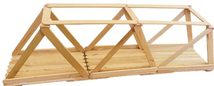
Rys. 3. Przęsło kratownicowe wykorzystujące trójkąt jako element konstrukcyjny
