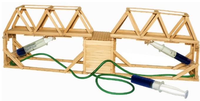
Rys. 5. Gotowy most z dwoma ruchomymi przęsłami podnoszonymi siłownikami hydraulicznymi Źródło: opracowanie własne.
