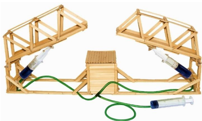
Rys. 6. Podnoszenie przęsła mostu zwodzonego siłownikami hydraulicznymi Źródło: opracowanie własne.
