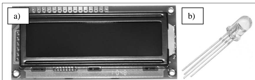
Rys. 3. a) wyświetlacz LCD 16 x 2 znaków, b) dioda RGB
