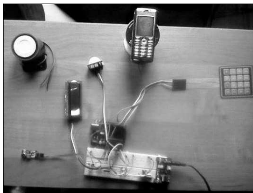
Rys. 5. Układ systemu alarmowego testowanego na płycie prototypowej
