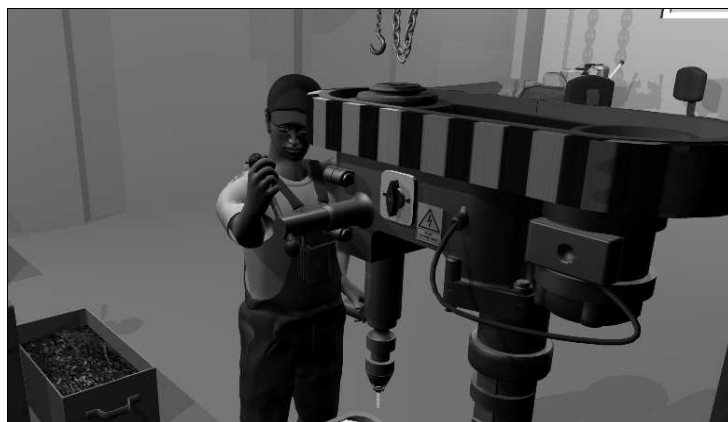
Rys. 5. Fragment animacji związanej z operowaniem przez pracownika pokrętłem jednoramiennym do opuszczania i podnoszenia wrzeciona jako przykład zastosowania narzędzi kinematyki prostej i odwrotnej podczas wizualizacji obsługi wiertarki kolumnowej
