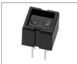
Rys. 2. Czujnik koloru CNY-70
