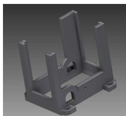
Rys. 5. Projekt obudowy robota nanosumo
