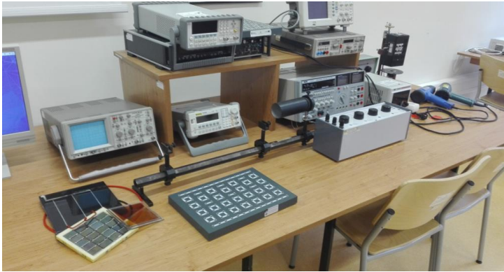
Rysunek 1. Stanowisko do badania fotoogniw
