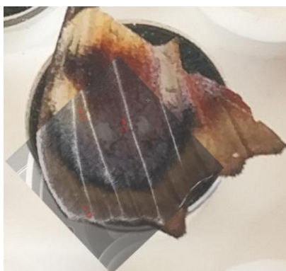
Rysunek 3. Zdjęcie fragmentu skrzydła w mikroskopie SEM wraz z opisanymi miejscami wykonania badania nałożone na zdjęcie skrzydła w celu zlokalizowania badanych obszarów
