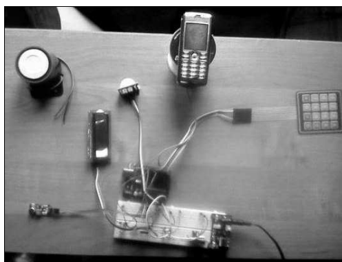
Rys. 5. Układ systemu alarmowego testowanego na płycie prototypowej
