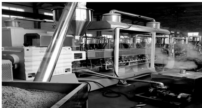
Rys. 1. Granulator SJMS65/132PP PE PVC WPC – na pierwszym planie zasobnik mączki drzewnej Fig. 1. SJMS65/132PP PE PVC WPC granulator - wood flour hopper in the foreground
