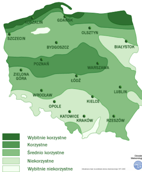
Ryc. 10. Warunki inwestycji pod względem zasobów wiatru na podstawie obserwacji prowadzonych w latach 1971–2000
